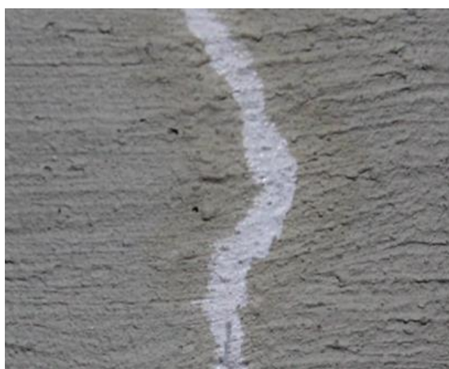
Fot. 4. Zamknięcie rysy przez kryształ soli, brak sączenia. Efekt po 21 dniach.
